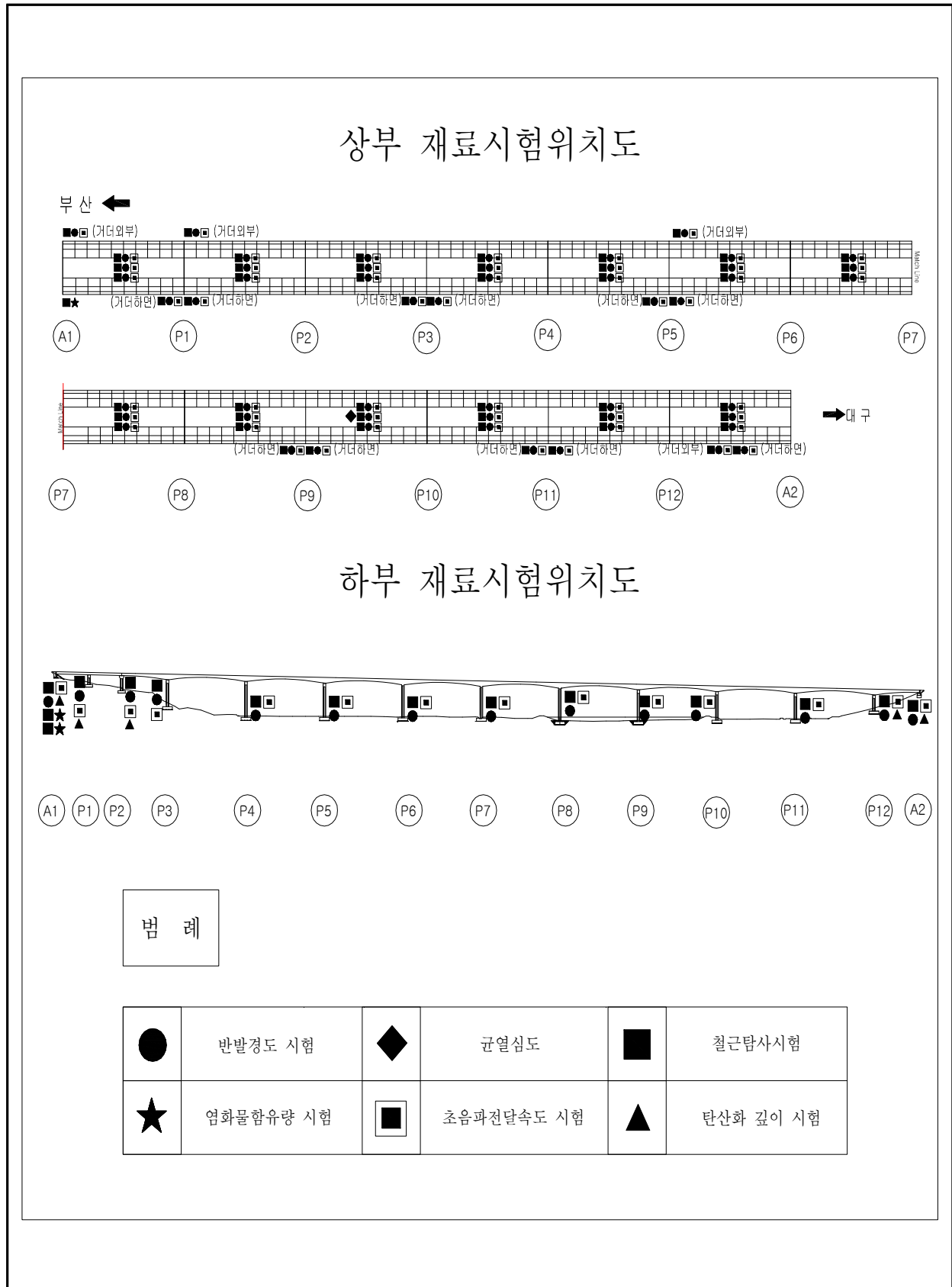
【그림 3.4.2】 콘크리트 내구성조사 위치도(부산)
